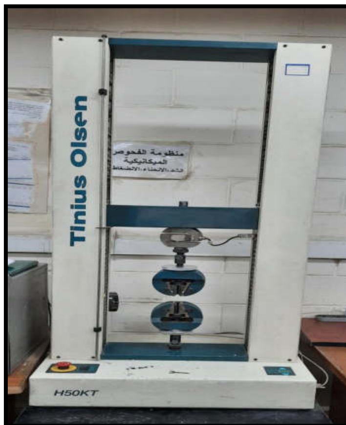
الشكل (3-7):- يوضح منظومة جهاز اختبار الانحناء (Bending Test).
